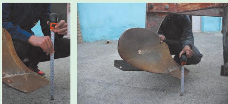
شکل ۱-۳۰. اندازه‌گیری فاصله تیغه جهت تراز عرضی
