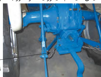
• تنظیم همپوشانی: این تنظیم به طور معمولی در کارخانه سازنده صورت می‌گیرد. اما در برخی از گاوآهن‌ها به خصوص گاوآهن برگردان دار، مختصراً تغییر در آن می‌توان ایجاد کرد. هدف از این تنظیم آن است که بین ردیف‌های شخم یکنواختی حاکم باشد. یعنی این‌که نه بین آنها فاصله باشد و نه این‌که روی هم برسید. همپوشانی باید به گونه‌ای تنظیم شود که فاصله انتهای تیغه خیش آخر از دیواره داخلی چرخ راست تراکتور پنج سانتی‌متر باشد (شکل ۱-۲۸).
