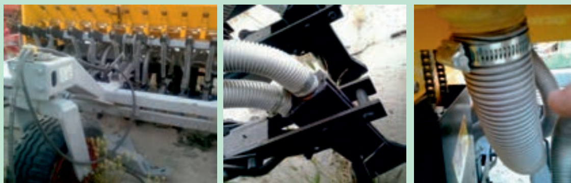
شکل ۴۶- ماشین کاشت دیم دارای لوله‌ها و شیلنگ‌های متعددی اغلب با بست پیچی یا پرسی هستند
