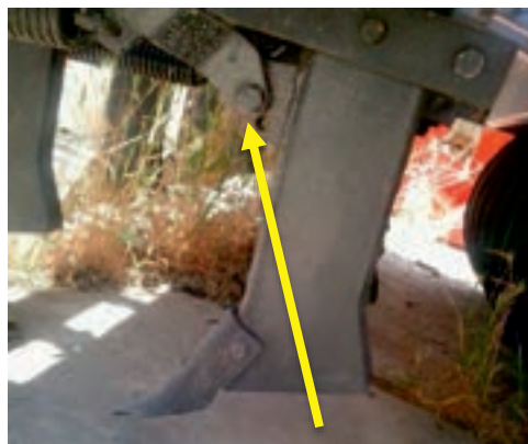
شکل ۵۴- سوراخ روی بازوی بیلچه شیار بازکن
