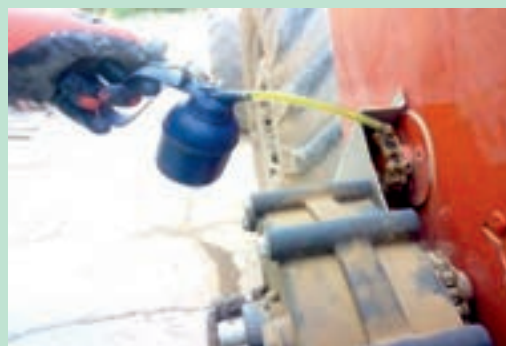
شکل ۴۳- روغن کاری چرخ دنده‌ها
