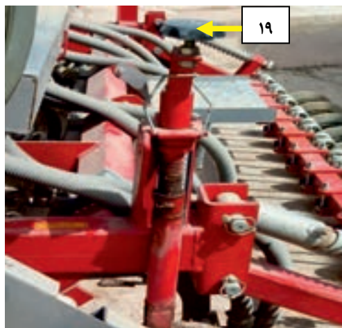
شکل ۳۹- اهرم تنظیم عمق کاشت
