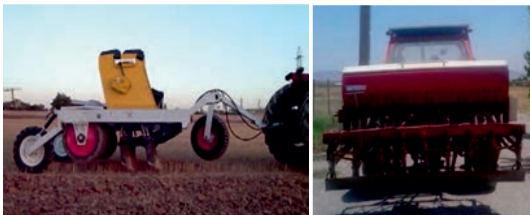
شکل ۴۷- خطی کارهای سوار و کششی در دیم‌کاری
