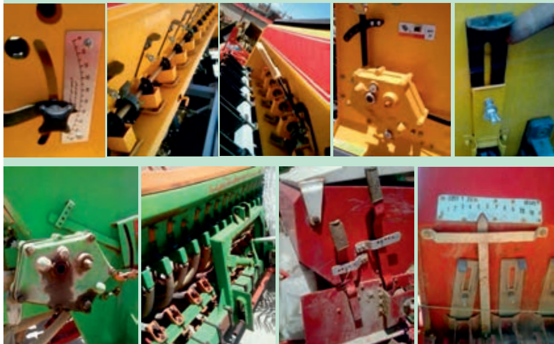
شکل ۵۷- برخی از تجهیزات و ساز و کارهای تنظیم در انواعی از ماشین‌های کاشت دیم
