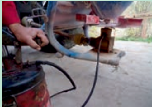
شکل ۱۵- گریس کاری گاردان و بذریاش
