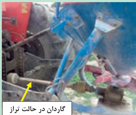
شکل ۱۶- نمایی از موازی بودن گاردان با سطح افق
