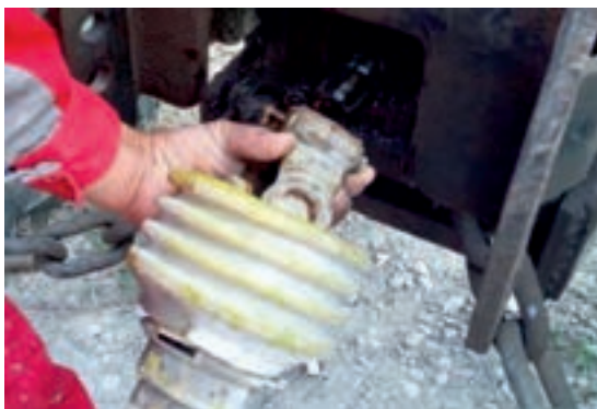
شکل ۱۱- اتصال گاردان به تراکتور
