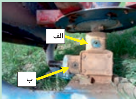
شکل ۱۳- تمیز کردن گریسخورها و مکان آنها
