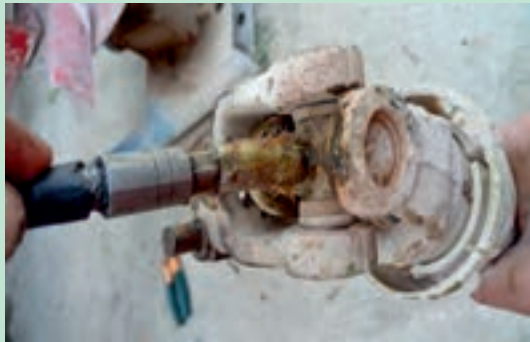
شکل ۱۵- گریس کاری گاردان و بذریاش
