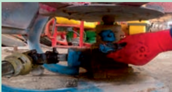
شکل ۱۳- تمیز کردن گریسخورها و مکان آنها
