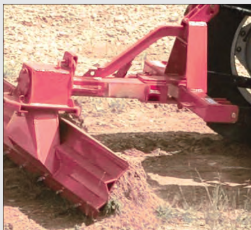
شکل ۲۶-۲ تیغه پشت تراکتوری متصل به تراکتور
