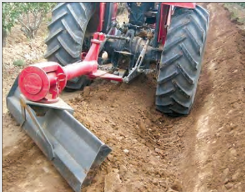
شکل ۲۷-۲- زاویه تیغه و ریزش خاک در چاله
