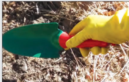
شکل ۲-۲- برداشت نمونه خاک برای تعیین رطوبت خاک
