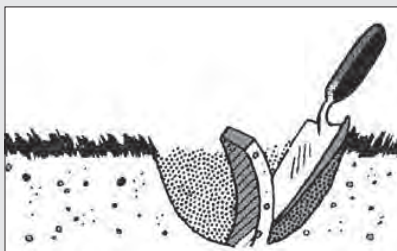
شکل ۱۴-۲ روش برداشت نمونه با بیل یا بیلچه
