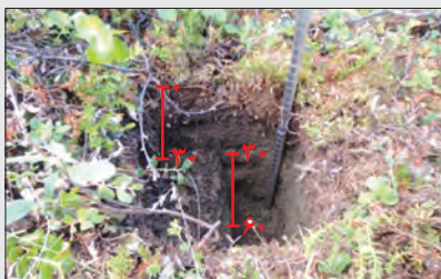
شکل ۱۵-۲ روش نمونه‌برداری از دو عمق ۳۰ و ۶۰ سانتی‌متر
