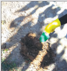
شکل ۲-۲- برداشت نمونه خاک برای تعیین رطوبت خاک
