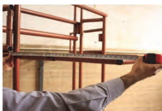
شکل ۱۶- رعایت فواصل اجزاء دستگاه
