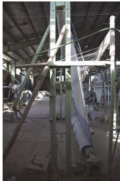
شکل ۴۸- دستگاه متحرک با اتصالات پیچ و مهره
