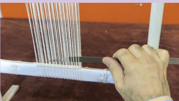
روش اشتباه در دست گرفتن سیخ بودکشی و حرکت آن
