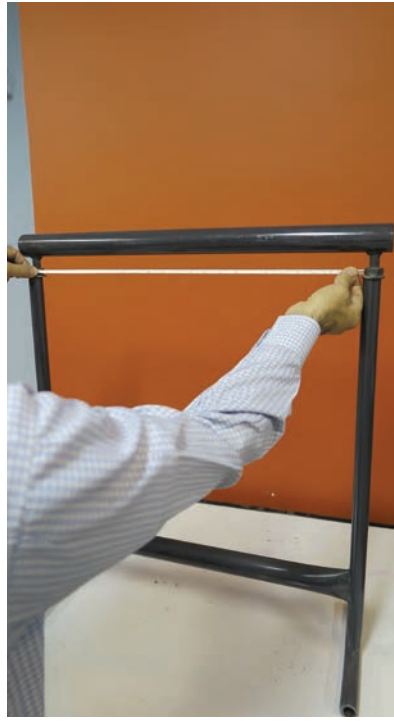
▲ تصویر ۱-۱۲ اندازه گیری فاصله دو سر بالای راست روها
