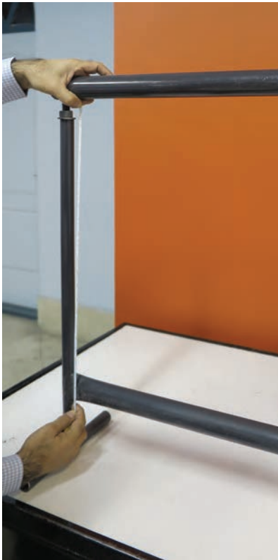
تصویر ۱-۸ ▲ اندازه گیری فاصله داخلی و سمت چپ دار
