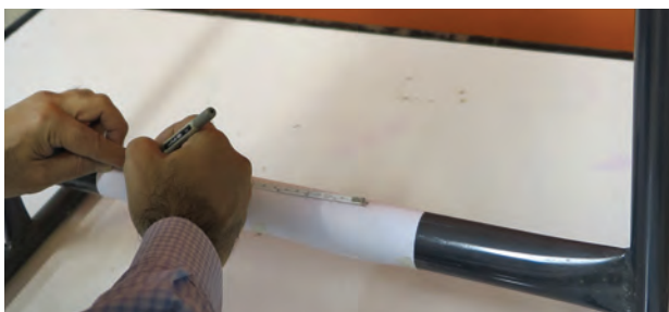
◀ تصویر ۱-۲۱ علامت گذاری فاصله های ده سانتی متری از دو طرف نقطه میانی زیر دار
