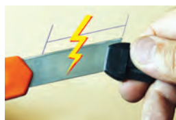
شکل ۱-۱۳- خطر در شکستن تیغه و پرتاب شدن قطعات آن به طرف انسان
