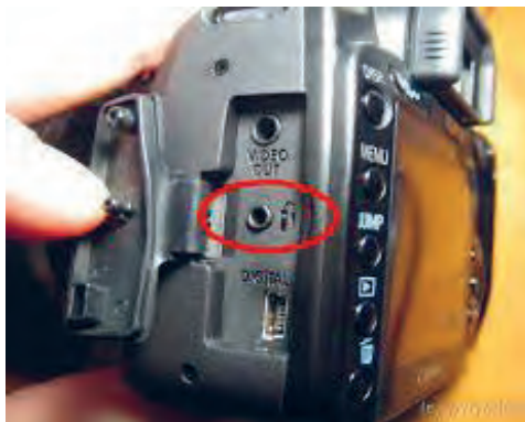
محل نصب دکلاشور سیمی بر روی بدنه دوربین
