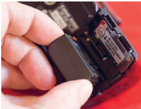
شیوه صحیح نصب باتری دوربین عکاسی
