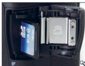
محل نصب کارت حافظه بر روی دوربین
