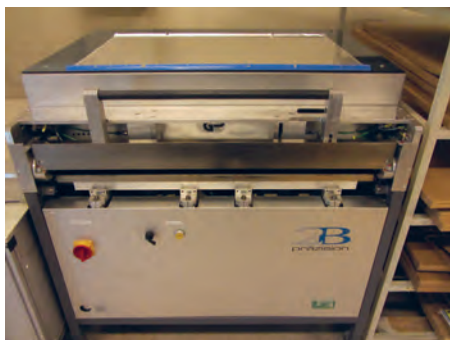
شکل ۱۷-۲ دستگاه قید کپی با نوردهی از پایین
