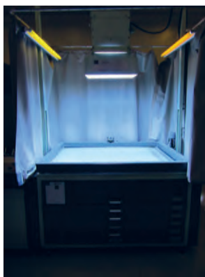
شکل ۱۶-۲ دستگاه قید کپی با نوردهی از بالا
