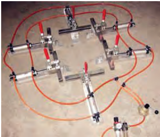
شکل ۵-۲۵- توری کش پنوماتیکی و گیره توری کشی به همراه مانیفولد
