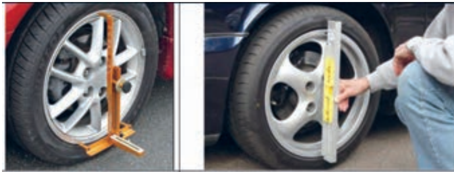
شکل ۴۲- ابزار مخصوص بررسی و تنظیم زوایای چرخ
