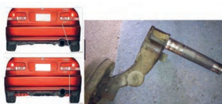
شکل ۴۵- خرابی بوش‌ها و تأثیر آن روی چرخ
