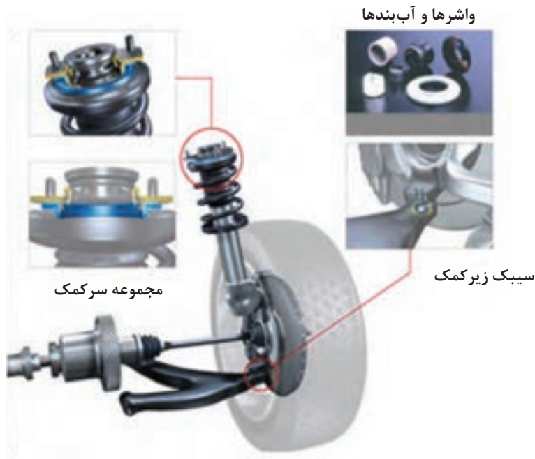
شکل ۳۴- برخی نقاط قابل تعمیر تعلیق مک فرسون
