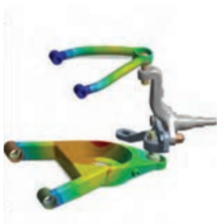
شکل ۱۵- سگدست و محور آن
