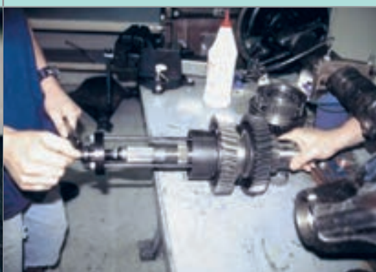
تفکیک اجزای مجموعه جعبه دنده از روی محورها با کمک پرس و ابزار مخصوص
