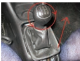
شکل ۲-۲۵- خارج کردن سری و گردگیر دسته دنده
