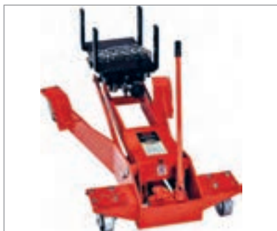
شکل ۲۷-۲ انواع جک نگهدارنده جعبه‌دنده
