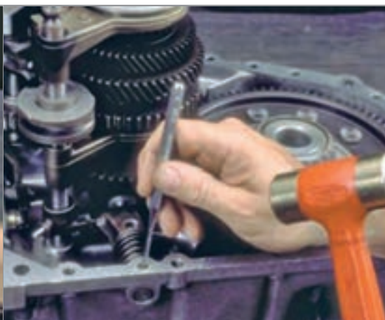
خارج کردن پین نگهدارنده اهرم تعویض دنده
