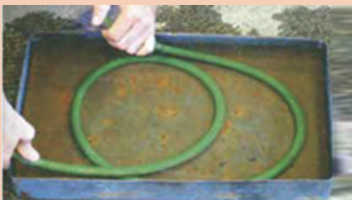
شکل ۳-۳۸- کنترل سلامت شیلنگ‌ها
