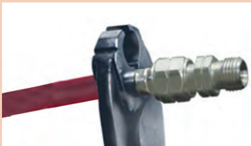
شکل ۳-۳۶- شیار انداختن روی حلقه دور شیلنگ (برای سفت کردن شیلنگ موج‌دار)
