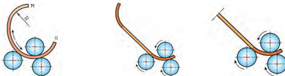
شکل ۷-۲- مراحل رول کاری با دستگاه نورد صاف‌کننده ساده
