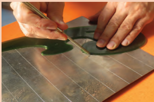
شکل ۳۴-۱- خط کشی ورق فلزی با پیستوله
