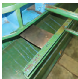
شکل ۸-۱- استفاده از شابلون جلویی و پشتی دستگاه
