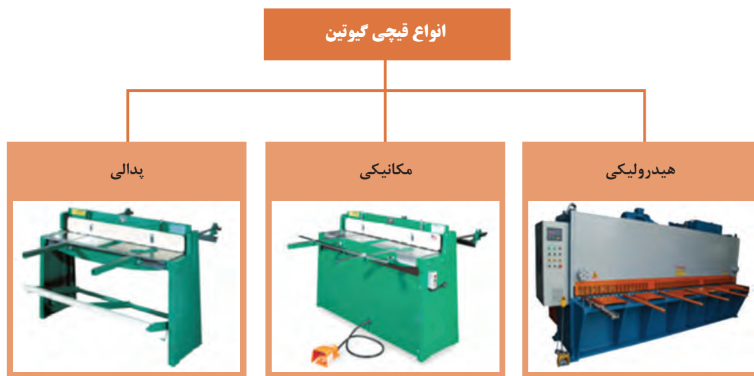
شکل ۳-۱- انواع گیوتین از نظر نحوه انتقال قدرت
