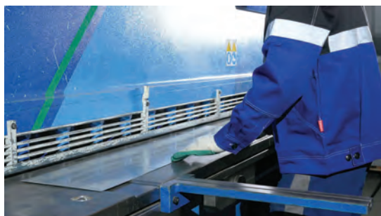
شکل ۲-۱- برش کاری با گیوتین
