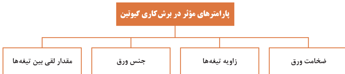
شکل ۱-۱۰- پارامترهای برش کاری با گیوتین
