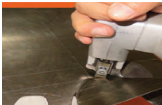
شکل ۱-۲۱- روش برش کاری با نیبلر دستی
