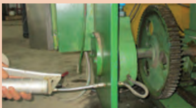
شکل ۱-۱۶- سرویس دوره‌ای گیوتین
