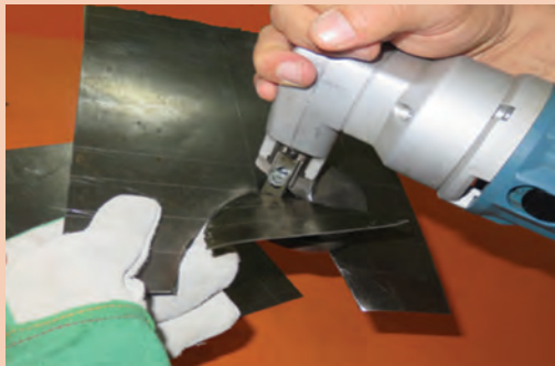
شکل ۳۵-۱- برش کاری با قیچی نیبلر
