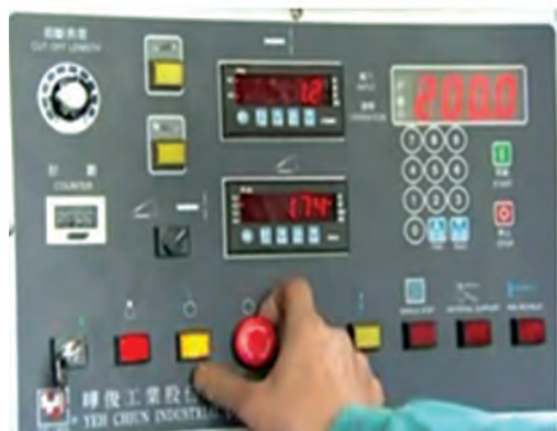
شکل ۹-۱- نمایی از صفحه تنظیمات در گیوتین CNC
