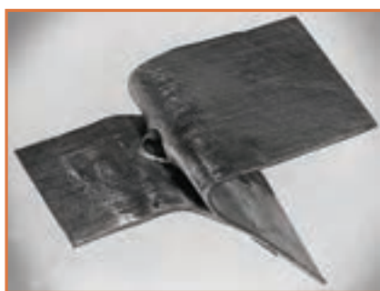
شکل ۱۹- نتیجه مطلوب در آزمون خم کاری
