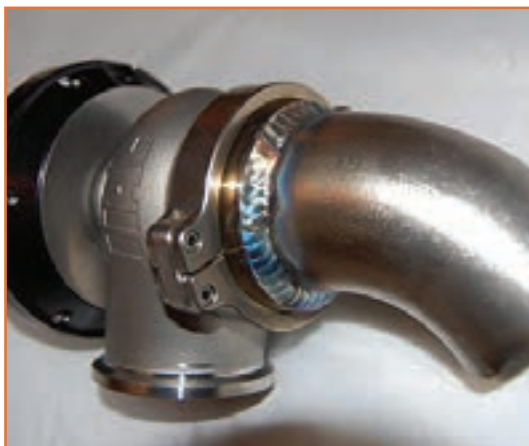
الف - جوش کاری دو قطعه فولادی
