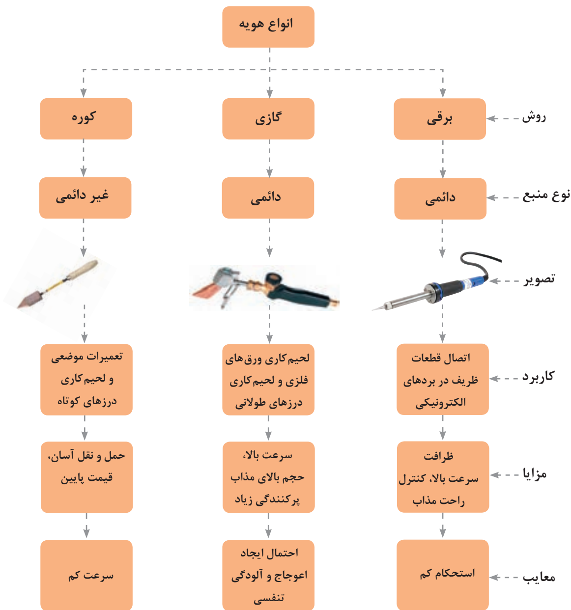
شکل ۱۸- انواع روش‌های لحیم کاری با هویه
