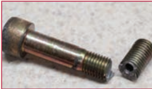
شکل ۳۰-۵. یک پیچ بریده شده بر اثر بارگذاری پیچشی
