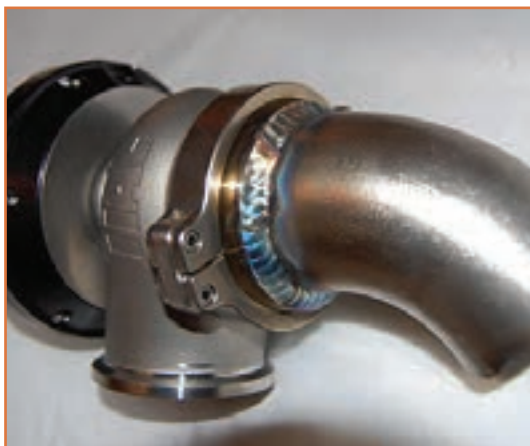
الف - جوش کاری دو قطعه فولادی
