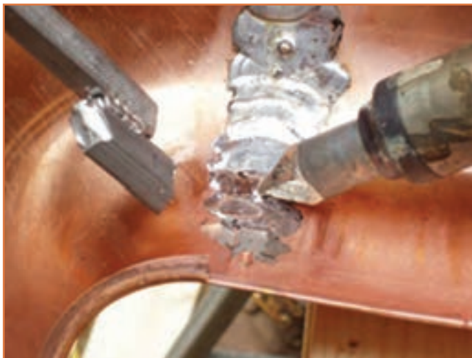
شکل ۲۲ - پرکردن درز اتصال به وسیله مذاب لحیم
