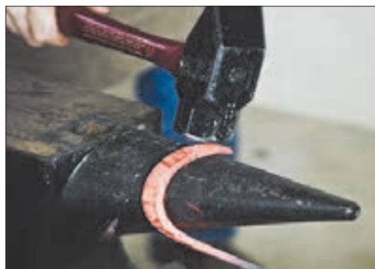
شکل ۳-۴- خم کاری دستی به کمک قالب و چکش
