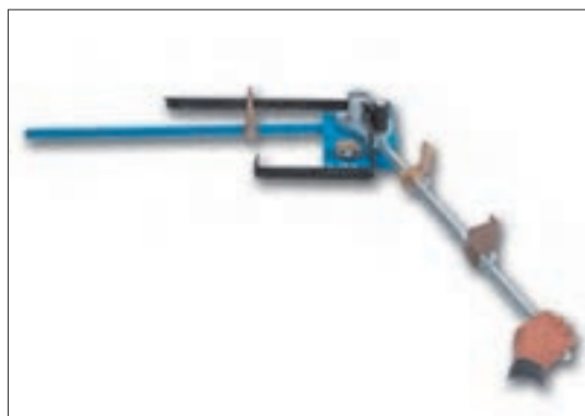
شکل ۳-۵- خم کاری دستی تسمه با ابزار کمکی
