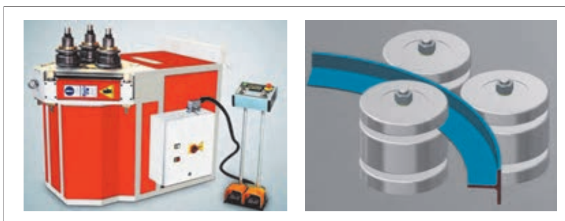
شکل ۳-۱۸- دستگاه خم کن سه غلتکی عمودی
