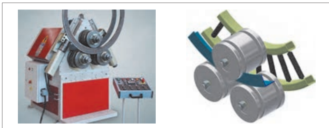
شکل ۳-۱۷- دستگاه خم کن سه غلتکی افقی
