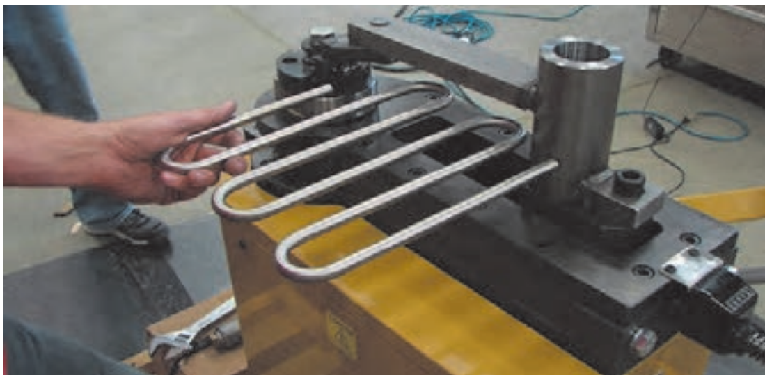
شکل ۲-۸: لوله خم شده - مبدل حرارتی
