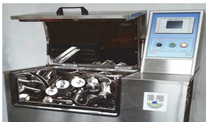
شکل ۲ یک عدد ماشین رنگرزی آزمایشگاهی تحت فشار
