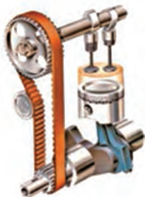
شکل ۳۱- روش سفت کردن چرخ و تسمه با پولی اضافه
