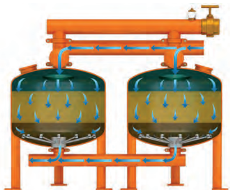
شکل ۶۰- روش تصفیه شنی و تمیز کردن شن‌ها
