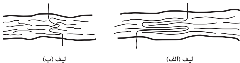
شکل ۵- نمایش قرار گرفتن مولکول‌های بلند و کوتاه در داخل لیف
