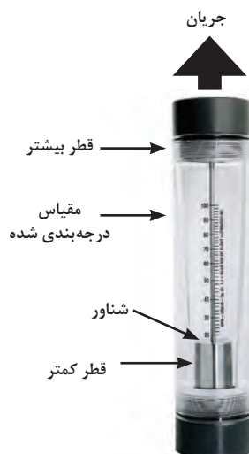
شکل ۷ - یک نمونه روتامتر معمولی
