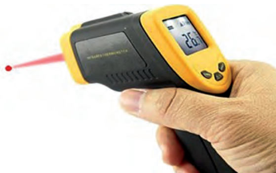
شکل ۴۰- دماسنج آذرسنج تشعشعی
