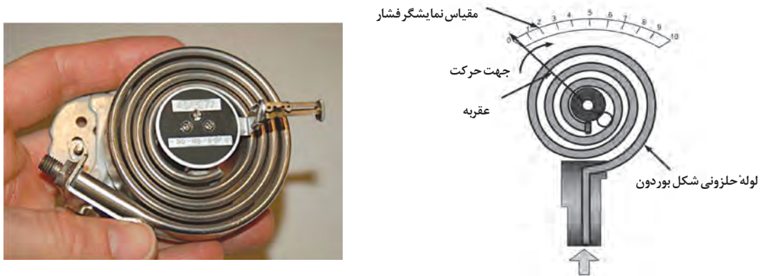
شکل ۲۲- لوله بوردون از نوع حلزونی
