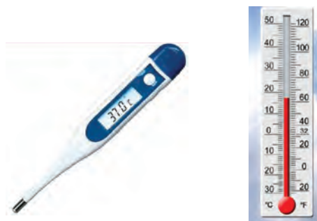
شکل ۴۲- نشانگر دیجیتالی دما (مصارف خانگی)
