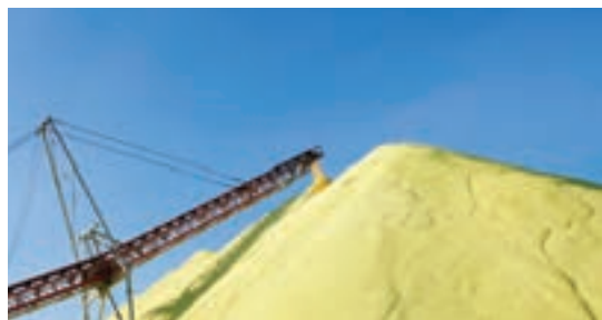
شکل (۱۲-۲) توده بزرگی از گوگرد در انتظار ورود به مجتمع سولفوریک‌سازی. گوگرد امی‌سوزانند و SO_2 پدید می‌آورند. این گاز را به کمک کاتالیزگر به SO_3 و سپس به H_2SO_4 تبدیل می‌کنند.
