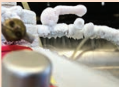
شکل ۱۲-۵- شیر و اتصالات یخ‌زده
