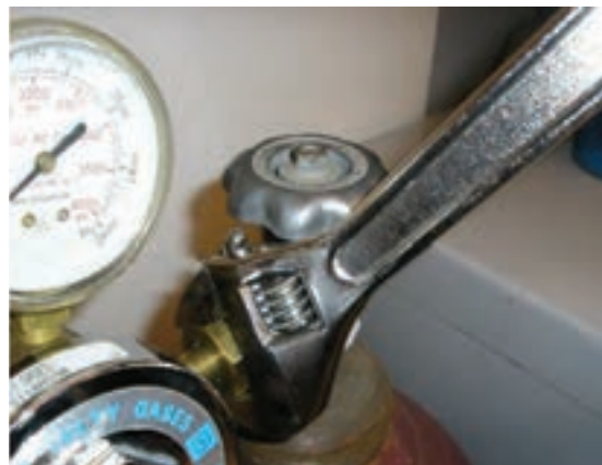
شیوه بستن شیر تنظیم به کپسول
