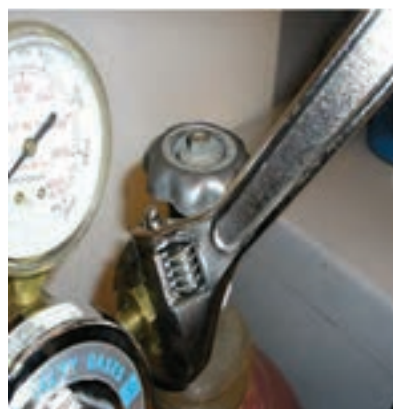
بازکردن شیر تنظیم از کپسول
