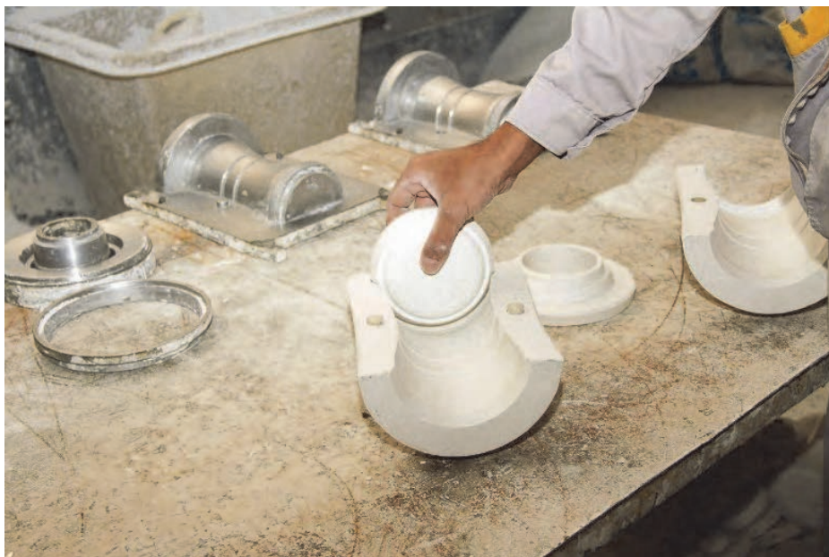
شکل ۵- یک قالب چند تکه
