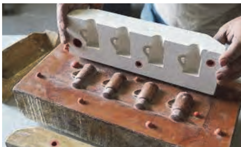
شکل ۴- قالب گچی با قابلیت ریخته‌گری چهار قطعه
