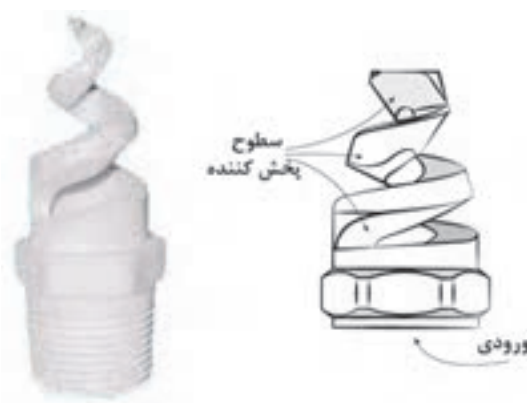
شکل ۲۴- افشانک نازلی نوع حلزونی
