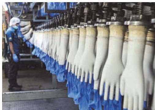
شکل ۱- قالب مورد استفاده در تولید دستکش
