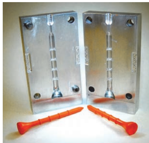
شکل ۳- قالب مورد استفاده در تولید میخ
