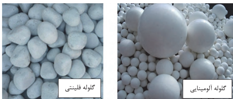
شکل ۱۸- گلوله‌های آلومینایی و فلینتی بال‌میل
