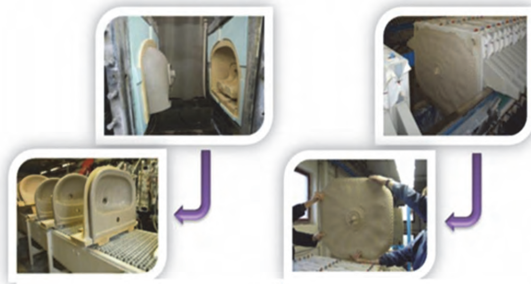
شکل ۵- الف) فیلتر پرس ب) ریخته‌گری دوغابی تحت فشار
