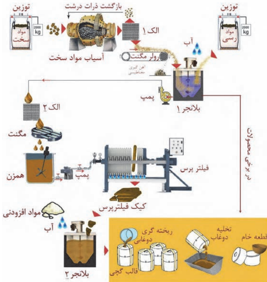
شکل ۱۱- فرایند ساخت دوغاب و شکل‌دهی قطعه
