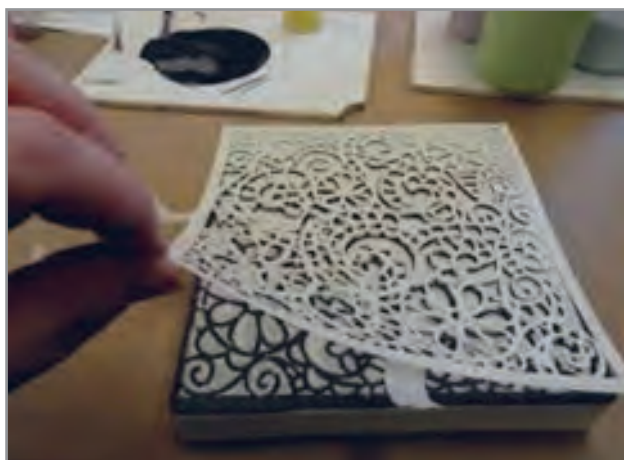
شکل ۳۴- لعاب‌زنی با روش چاپ استنسیل
