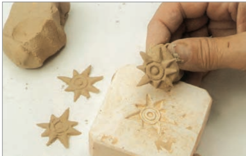
شکل ۱۳- فشار دادن مقداری گل درون قالب
