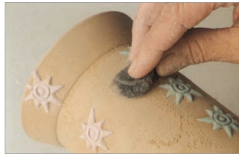
شکل ۱۴- پرداخت بدنه پس از قرار دادن طرح
