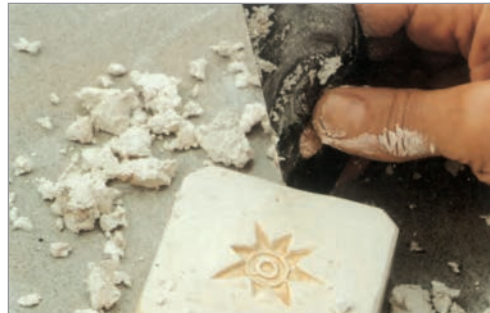
شکل ۱۲- تراشیدن طرح بر روی قالب گچی
