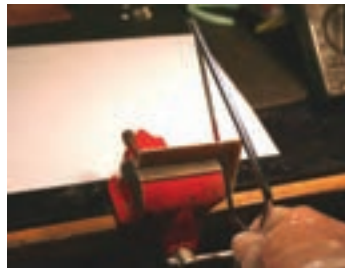
شکل ۷-۳- بریدن فیبر با اره آهن‌بر
