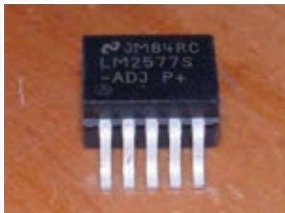
شکل ۲-۳۲ - یک نمونه آی سی مبدل DC به DC
