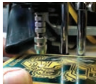
شکل ۳-۲۹- سوراخ کاری فیبر مدار چاپی
