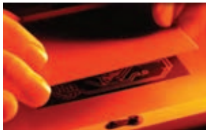
شکل ۳-۲۱- قرار دادن فیبر روی نقشه
