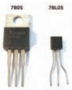
شکل ۲-۲- دو نوع بسته‌بندی TO۹۲ و TO۲۲۰
