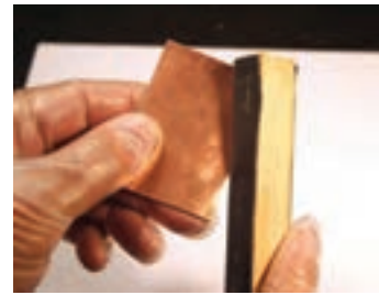
شکل ۶-۳- پرداخت کردن لبه فیبر
