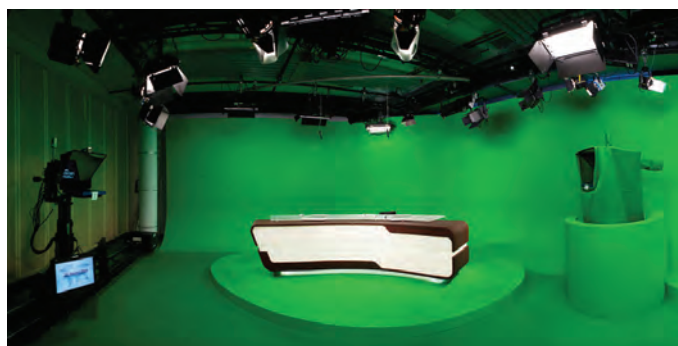
تصویر ۲۴- تمام قطعات داخل دکور با رنگ سبز پوشیده شده، برای امکان ایجاد تصاویر در همه نقاط صحنه استودیو مجازی
