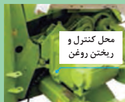
شکل ۶۵- جعبه دنده باردهی غلتک‌های تغذیه
