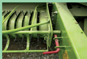
شکل ۱۵- پین نگهدارنده بردارنده
