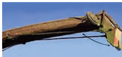
شکل ۵۸- حرکت عمودی کلاهک لوله تخلیه
