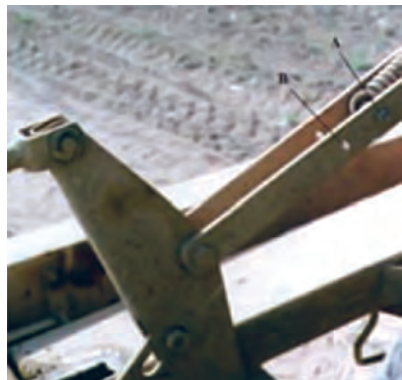
شکل ۲۹- تنظیم فنر شناوری
