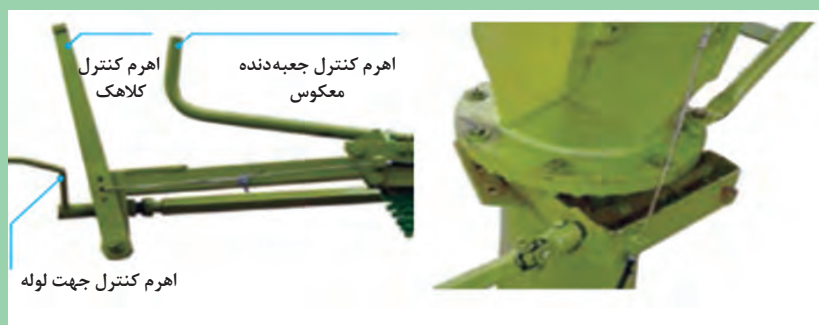
شکل ۶۱- اهرم‌های کنترل در اختیار کاربر
