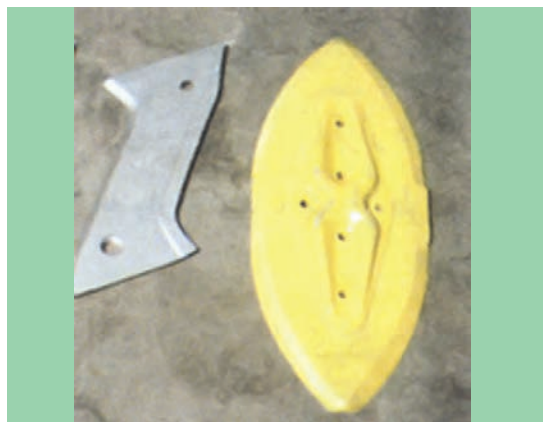
شکل ۴۸- شکل تیغه‌های بیضی و Z شکل
