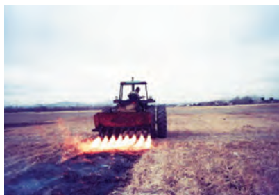
شکل ۲۰- دستگاه شعله افکن پشت تراکتوری
