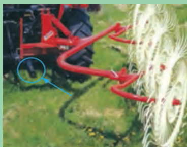
شکل ۹- اتصال شانه خورشیدی به تراکتور
