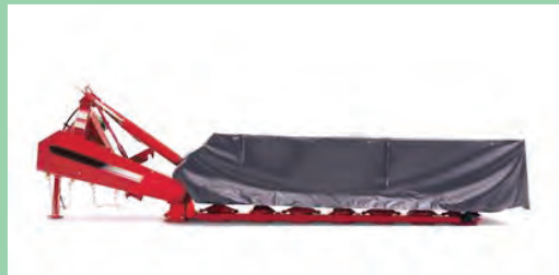
شکل ۱۰- حفاظ دستگاه دروگر استوانه‌ای و بشقابی
