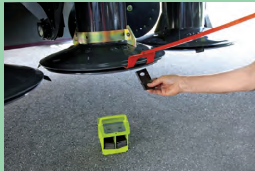
شکل ۲۰- نحوه تعویض تیغه در دروگر استوانه‌ای
