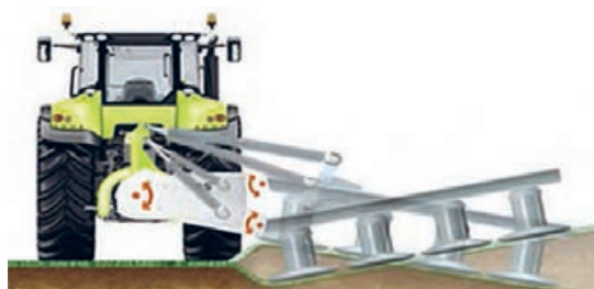
شکل ۱۲- حالت‌های کاری دروگر استوانه‌ای در شیب
