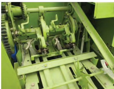
شکل ۲۴- چرخ دنده قطاعی جهت تنظیم طول بسته در دستگاه بسته‌بند
