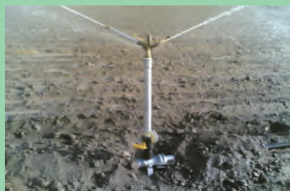
شکل ۲۷- آبپاش مستقر شده روی شیر خودکار
