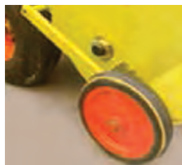
شکل ۱۹- چرخ نگهدارنده واحد بردارنده
