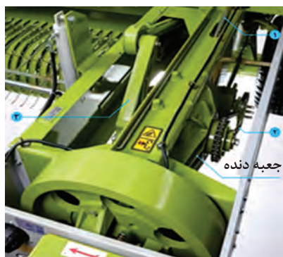
شکل ۱۲- مسیر انتقال توان در دستگاه بسته‌بند
