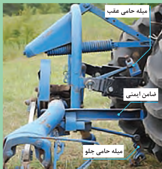
شکل ۲۱- نحوه اتصال دروگر شانه‌ای به تراکتور
