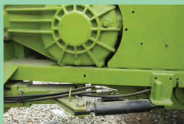
شکل ۱۷- جک هیدرولیک جهت تغییر وضعیت دستگاه از حالت حمل و نقل به حالت کار و بالعکس
