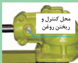
شکل ۶۶- جعبه دنده زانویی تیغه درو
