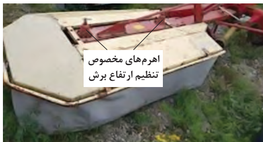
شکل ۲۸- اهرم‌های مخصوص تنظیم ارتفاع برش
