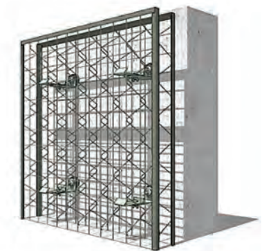
پانل فلزی در سیستم شبکه‌ای داربستی
