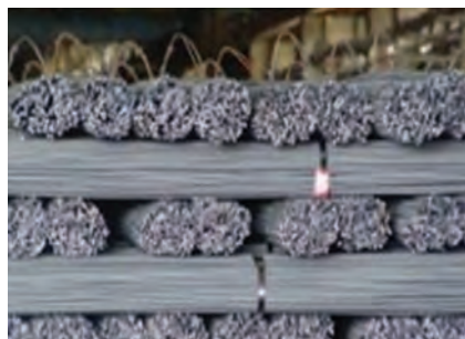
شکل ۱۸- میلگرد شاخه ای (۱۲ متری)
