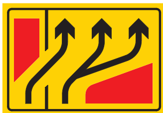
شکل ۴۵- نمونه‌ای از تابلوهای اخباری انحراف مسیر
