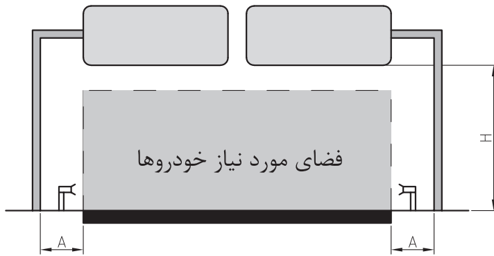
تابلوی بالاسری برای پهناي سواره‌رو (A برابر ۱/۵ متر و در صورت تنگي فضا يك متر، H برابر ۵/۲ متر)
