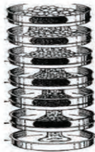
شکل ۷- سری الک های استاندارد دانه بندی خاک
