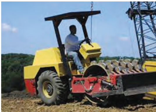
شکل ۱۱- غلتک از نوع پاچه بزی
