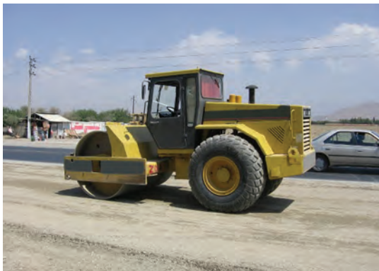
شکل ۱۰- غلتک از نوع ارتعاشی
