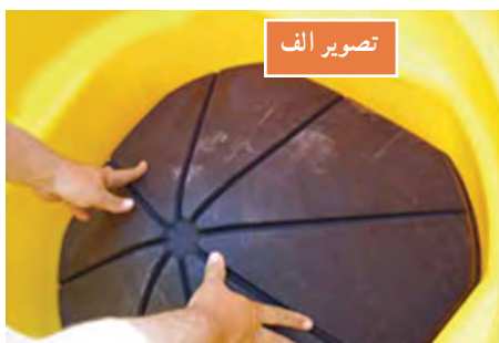
شکل ۲۲- چیدمان بشکه‌ها و قرار دهی مخروط درونی
