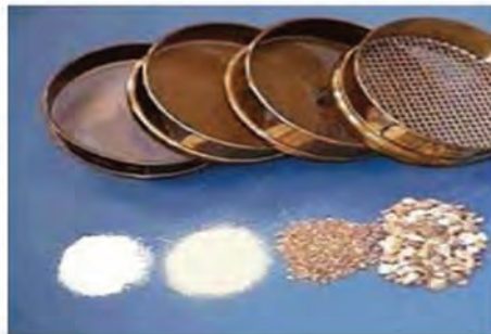
شکل ۷- سری الک های استاندارد دانه بندی خاک
