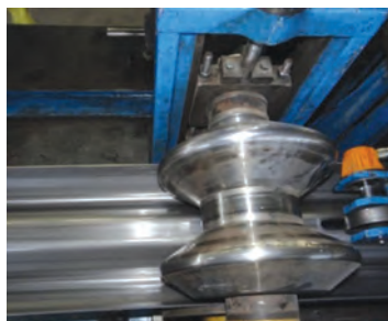
شکل ۴- ساخت و تولید گاردریل به روش نورد
