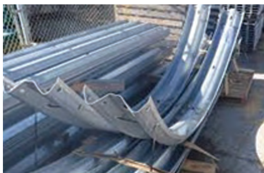
شکل ۶۶- سپری محدب گاردریل
