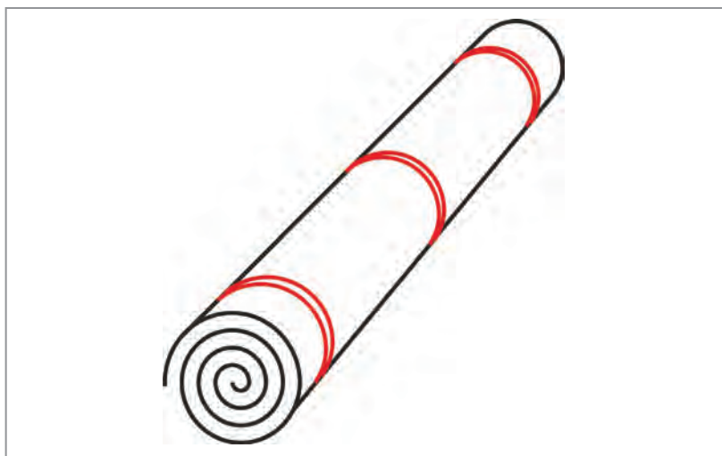
شکل ۴۰- روش بستن فرش لول شده با استفاده از طناب
