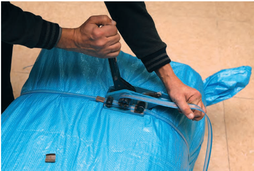
شکل ۲۲- نوارکشی روی بسته با نوار پلاستیکی
