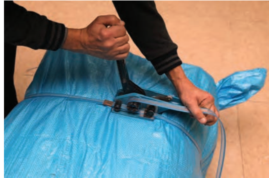
شکل ۸۵- کشیدن نوار به کمک ابزار نوارکش
