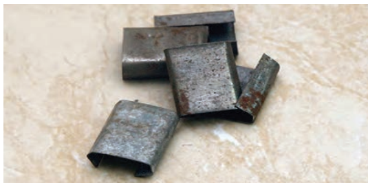
شکل ۲۵- بسته فلزی مخصوص نوارکشی
