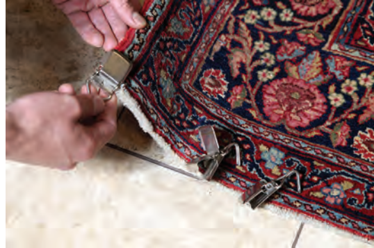
شکل ۱۰-۵- چگونگی اتصال گیره به فرش
