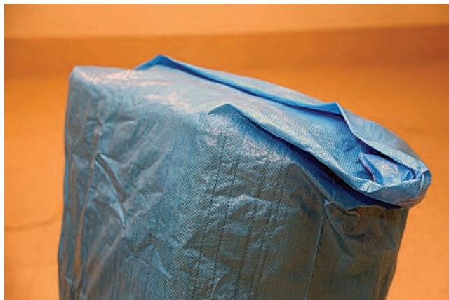
شکل ۷۹- تازدن لبه های دهانه گونی
