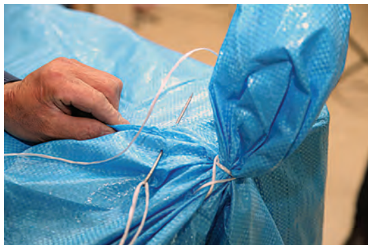
شکل ۸۰- جمع کردن گوشه‌های دهانه و دوختن آنها
