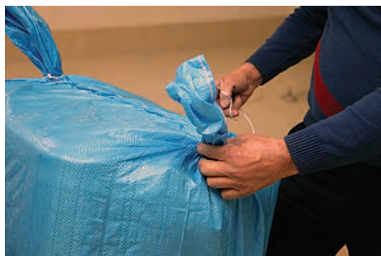
شکل ۸۱- دوختن دهانه گونی و جمع کردن اضافه آن در گوشه دهانه
