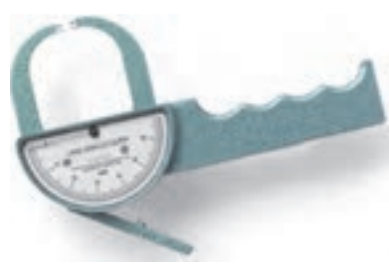
سه نوع مختلف کالیپر چین‌پوستی برای اندازه‌گیری چربی زیر پوستی به‌منظور بررسی ترکیب بدن
