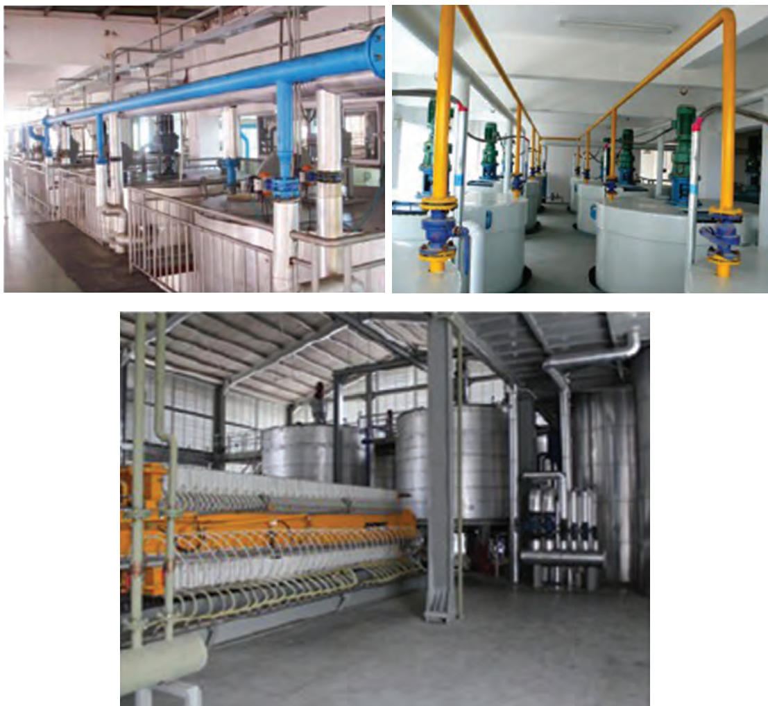
شکل ۱۰- سیستم تجهیزاتی جزء به جزء کردن روغن
