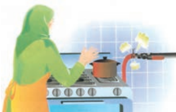
ب) طریقه نصب غلط
