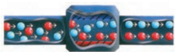
شکل ۴-۱۶- خنثی‌سازی اثر املاح آب توسط جریان مغناطیسی
