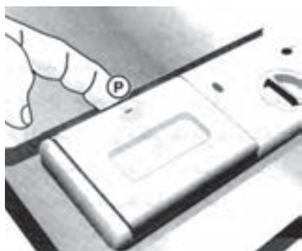
شکل ۱۵-۱۶- طریقه باز کردن در جاپودری اصلی
