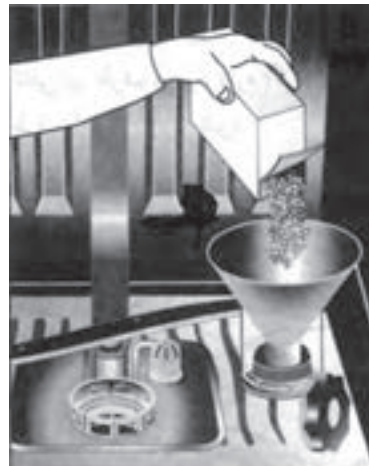
شکل ۹-۱۶- طریقه ریختن نمک در ماشین ظرفشویی اتوماتیک
