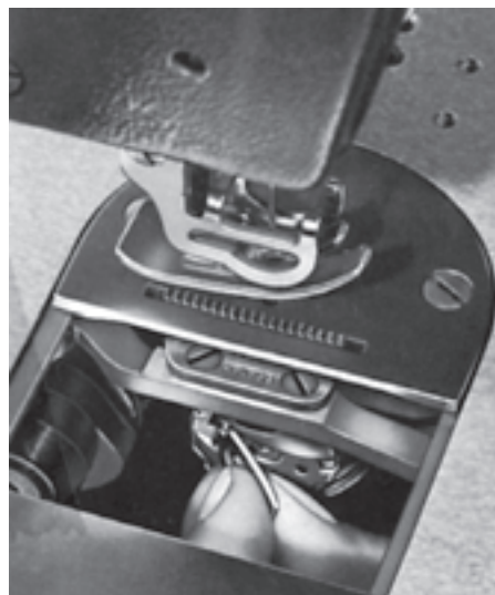
شکل ۴۸- الف - طریقه برداشتن ماکو از زیر چرخ
