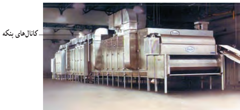
شکل ۱۴-۵ - تونل خشک کن
