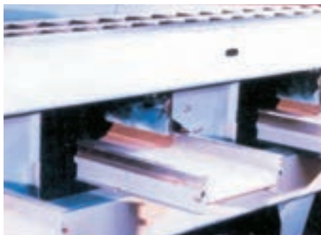
شکل ۱-۵. نقاله تسمه‌ای خروجی
