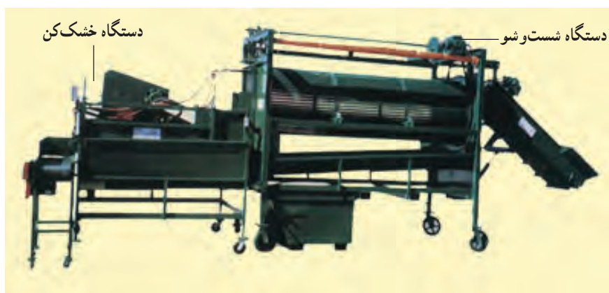
شکل ۱۵-۵ - ماشین مرکب شست‌وشو و خشک کن
