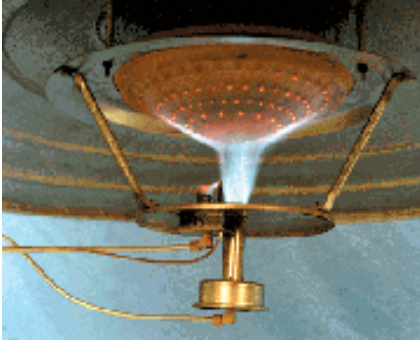
شکل ۳-۳۰- چگونگی توزیع شعله روی بازتابنده سرامیکی
