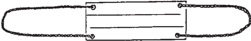
شکل ۸-۱۲- آویز تخته‌ای مخصوص حمل کالاهای شکستنی
