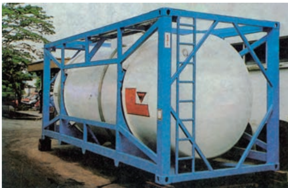
شکل ۳۴-۸ - مخزن گاز مایع کانتینری
