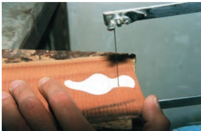
تصویر ۴- ۱۰- ۲- نحوه برش لایه چوبی بر اساس الگوی کاغذی. چنانچه ملاحظه می شود تیغه کماناره مماس به لبه کاغذ برش می دهد.
