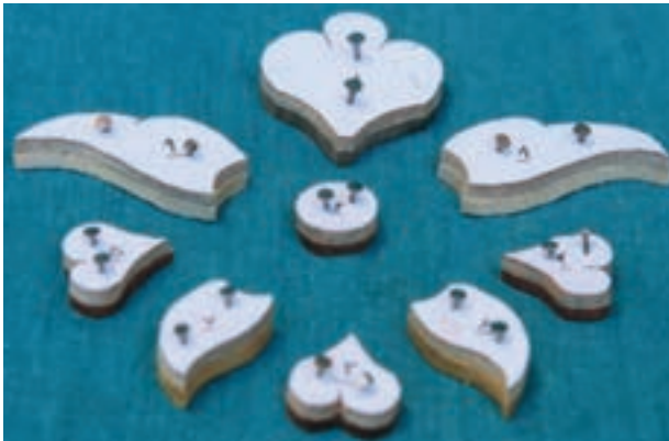
تصویر ۱۹ - ۱۰ - ۲ - قطعات برش خورده براساس الگوهای تخته سه لایی، چنانچه ملاحظه می شود هنوز الگوها روی قطعات قرار دارند.
