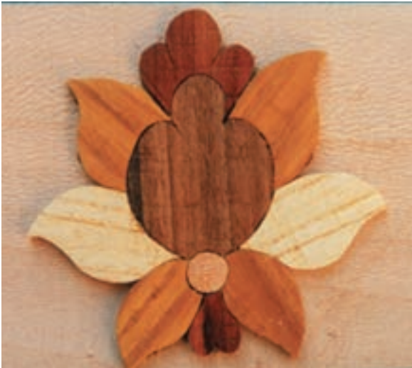
تصویر ۱۰- ۱- ۲- بعد از اصلاح قطعات می توان آنها را در کنار هم روی یک سطح صاف چسباند و کاغذ الگو را نیز از آنها جدا نمود.
