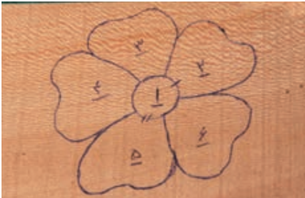
تصویر ۱۳- ۸- ۲- ترسیم یک شکل چند جزئی روی یک لایه چوبی
