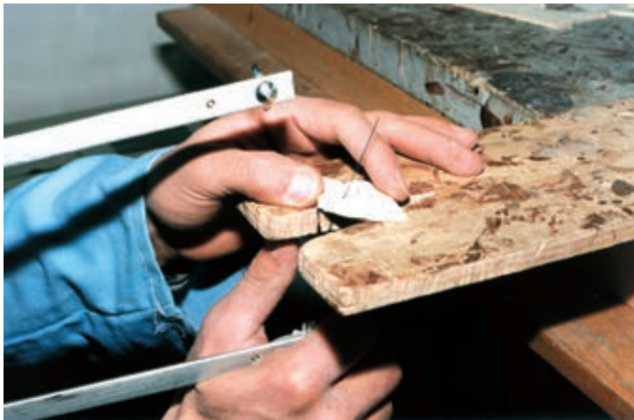
تصویر ۱۸ - ۸ - ۲ - بعد از برش خط بیرونی شکل و سوراخ نمودن آن لازم است یک سر تیغه‌اره از سوراخ رد شده و دوباره به پیچ کمان‌اره بسته شود.
