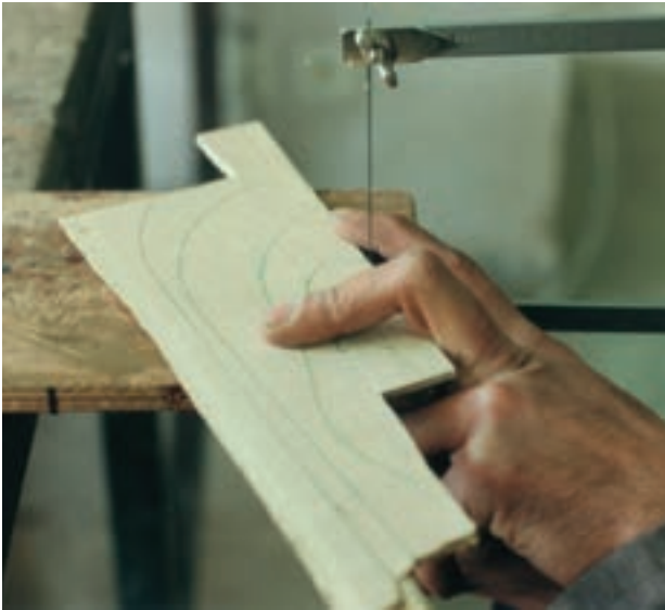
تصویر ۴ - ۷ - ۲ - شیوه گرفتن قطعه در حال برش روی لبه کار
